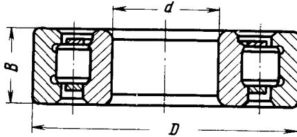
Ložisko hřídele hlavní páky řízení koncové
